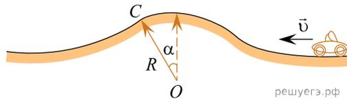
22. Автомобиль массой  $m = 1$  т движется по дороге со скоростью, модуль которой  $v = 30 \frac{\text{м}}{\text{с}}$ . Профиль дороги показан на рисунке. В точке  $C$  радиус кривизны профиля  $R = 0,34$  км. Если направление на точку  $C$  из центра кривизны составляет с вертикалью угол  $\alpha = 30,0^\circ$ , то модуль силы  $F$  давления автомобиля на дорогу равен ... кН.
