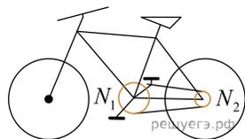
3. Диаметр велосипедного колеса  $d = 66$  см, число зубьев ведущей звездочки  $N_1 = 44$ , ведомой —  $N_2 = 14$  (см. рис.). Если велосипедист равномерно крутит педали с частотой  $\nu = 82$  об/мин, то модуль скорости  $V$  велосипеда равен ... **км/ч**.
