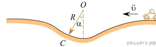
24. Автомобиль массой  $m = 1,1$  т движется по дороге, профиль которой показан на рисунке. В точке  $C$  радиус кривизны профиля  $R = 0,41$  км. Направление на точку  $C$  из центра кривизны составляет с вертикалью угол  $\alpha = 30,0^\circ$ . Если модуль силы давления автомобиля на дорогу в этой точке  $F = 7,7$  кН, то модуль скорости  $v$  автомобиля равен ...  $\frac{\text{м}}{\text{с}}$ .
