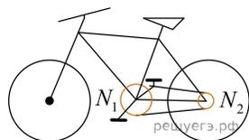
4. Диаметр велосипедного колеса  $d = 70$  см, число зубьев ведущей звездочки  $N_1 = 28$ , ведомой —  $N_2 = 24$  (см. рис.). Чтобы ехать с постоянной скоростью, модуль которой  $V = 12$  км/ч, велосипедист должен равномерно крутить педали с частотой  $\nu$  равной ... **об/мин**.
