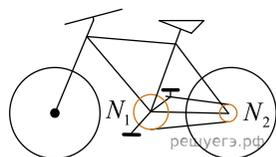
2. Диаметр велосипедного колеса  $d = 70$  см, число зубьев ведущей звездочки  $N_1 = 48$ , ведомой —  $N_2 = 14$  (см. рис.). Если велосипедист равномерно крутит педали с частотой  $\nu = 84$  об/мин, то модуль скорости  $V$  велосипеда равен ... **км/ч**.
