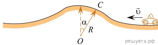
21. Автомобиль движется по дороге со скоростью, модуль которой  $v = 86,4$  км/ч. Профиль дороги показан на рисунке. В точке  $C$  радиус кривизны профиля  $R = 349$  м. Направление на точку  $C$  из центра кривизны составляет с вертикалью угол  $\alpha = 30,0^\circ$ . Если модуль силы давления автомобиля на дорогу  $F = 6,16$  кН, то масса  $m$  автомобиля равна ... кг.
