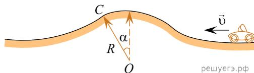
23. Автомобиль массой  $m = 1,0$  т движется по дороге со скоростью, модуль которой  $v = 72 \frac{\text{км}}{\text{ч}}$ . Профиль дороги показан на рисунке. В точке  $C$  радиус кривизны профиля  $R = 0,17$  км. Если направление на точку  $C$  из центра кривизны составляет с вертикалью угол  $\alpha = 30,0^\circ$ , то модуль силы  $F$  давления автомобиля на дорогу равен ... кН.
