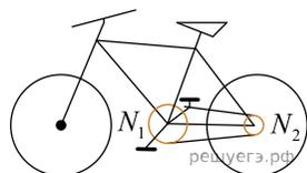
5. Диаметр велосипедного колеса  $d = 66$  см, число зубьев ведущей звездочки  $N_1 = 32$ , ведомой —  $N_2 = 21$  (см. рис.). Чтобы ехать с постоянной скоростью, модуль которой  $V = 18$  км/ч, велосипедист должен равномерно крутить педали с частотой  $\nu$  равной ... **об/мин**.
