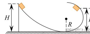
19. С высоты  $H = 50$  см из состояния покоя маленький брусок начинает соскальзывать по гладкой поверхности, плавно переходящей в полуцилиндр радиусом  $R = 26$  см (см. рис.). Если траектория движения бруска лежит в вертикальной плоскости, то высота  $h$ , на которой брусок оторвется от внутренней поверхности полуцилиндра, равна ... см.
